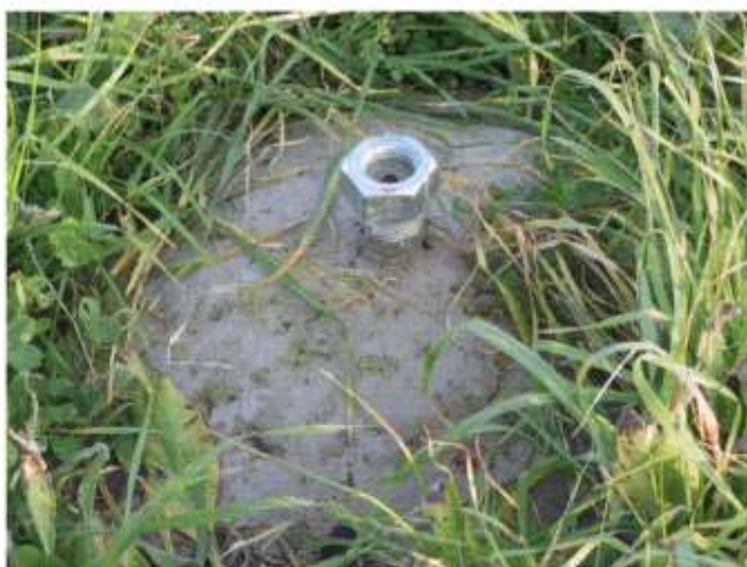
Predisposizione di un punto di controllo a terra GPS
